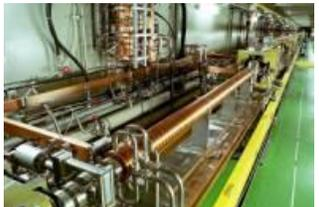
1.3 GeV S-band Electron LINAC (~70m)
